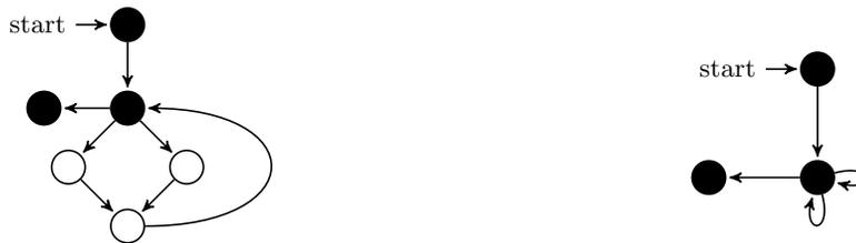
**Fig. 2.** En noir, les noeuds de  $P$ . À gauche, un graphe de flot de contrôle, et à droite son équivalent avec uniquement les noeuds de  $P$ . L’un des noeuds contient deux boucles, chacune correspondant à un chemin possible dans le graphe de gauche.
